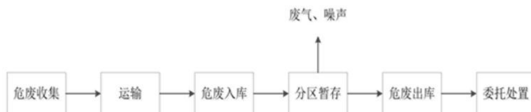
图 2-3 生产工艺流程及产污环节
